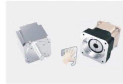
步驟1: 探試馬達軸上的防銹劑、潤滑脂等。
